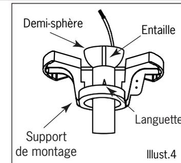
**N.B.:** Lorsque vous installez un ventilateur sur un plafond en pente, assurez-vous que l'entaille sur la ferrure soit face à la pente du plafond. Dépendant de l'angle de cette pente, une tige plus longue peut être requise afin d'empêcher les pales de cogner le plafond.
