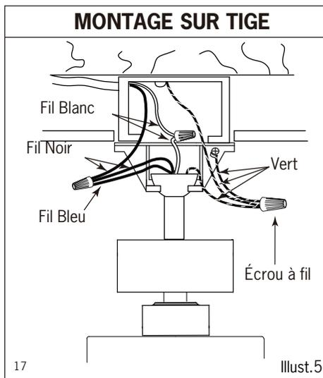
**N.B.:** Lorsque les fils sont branchés, pousser soigneusement les fils et les écrous à fils dans la boîte électrique en vous assurant que les fils ne sont pas gênés par l'hémisphère ou la tige lorsque vous positionnez la ferrure de montage.
