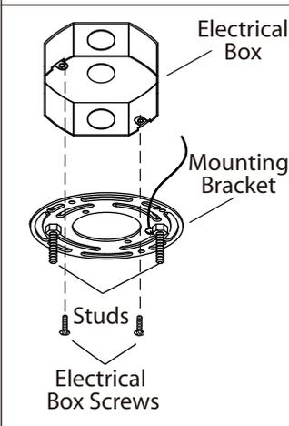
3. Posez la ferrure d'installation à la boîte de sortie électrique à l'aide des vis de la boîte (en sus). Assurez-vous que les goujons de la ferrure d'installation font face vers l'extérieur de la boîte électrique.
