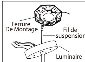
4. Utiliser le fil de suspension pour suspendre le luminaire tel qu'illustré afin de faciliter la connexion des fils.
