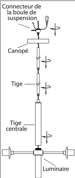
1. Vissez la tige du centre à la fixture. Installez la longueur de colonne requise en faisant passer le fil dans la colonne puis en vissant la colonne sur le luminaire.
